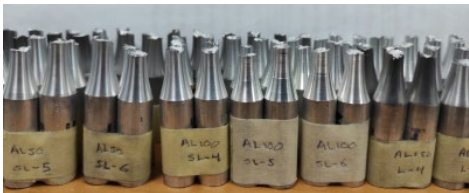
Fig. 2.6 Probetas ensayadas de aluminio 6061-T6
