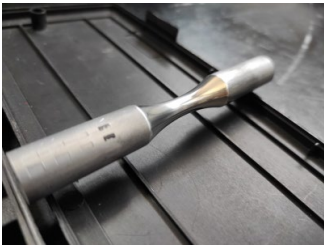
Fig. 2.5 Probeta pulida de aluminio 6061-T6
