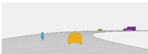
Fig. 4. Actores dentro de la simulación, Auto Ego en color amarillo, un camión en color morado, vehículo particular en verde y una bicicleta en color azul
