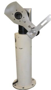
Fig. 1. Robot manipulador experimental de transmisión directa con 3 gdl.
