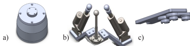
Figura 4. a) Base fija, b) Base giratoria y c) Efector final.
