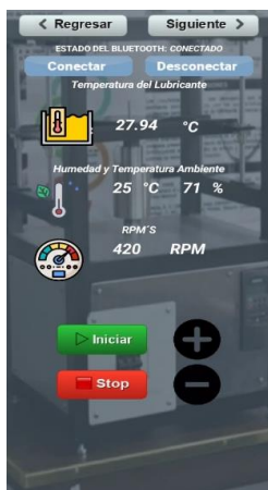
Figura 6. Interfaz de la aplicación mediante una prueba en el tribómetro.
