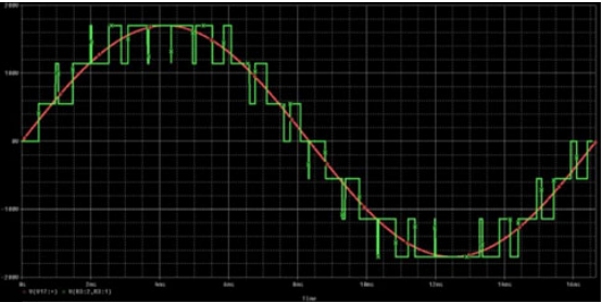
Fig. 12. Señal de salida de la topología R6 contra la señal moduladora de referencia.
