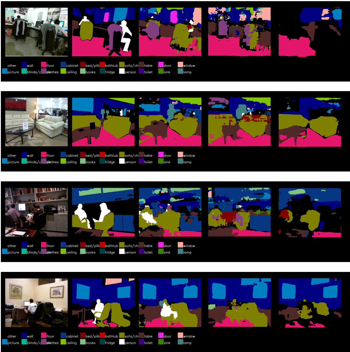
Fig. 2. Resultado de pruebas realizadas con la SBC NVIDIA Jetson TX1. De izquierda a derecha: imagen de entrada a color, imagen etiquetada, salida de la red propuesta, imagen segmentada por arquitectura U-Net, resultados con ESPNet.
