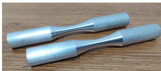
Fig. 3.2 Probetas de aluminio 6061-T6
