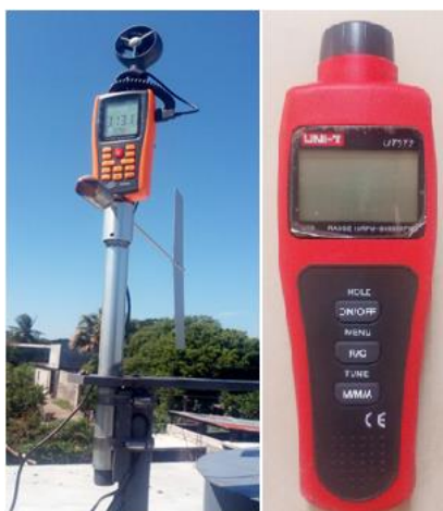
Fig. 4. Izquierda: Arreglo anemómetro digital-veleta. Derecha: Tacómetro digital.
