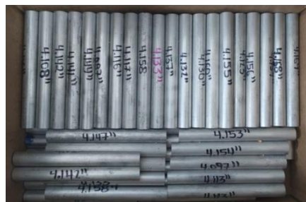
Fig. 3.1 Barras de aluminio 6061-T6 cortadas en tramos.
