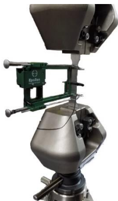
Fig. 1. Prueba de tensión de perfil 6063-T5.
