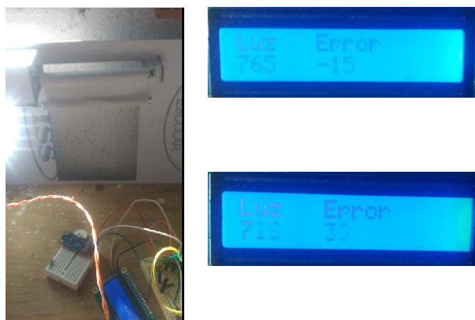
Fig 4 Arquitectura de un Sistema de persiana controlada por inferencia difusa
