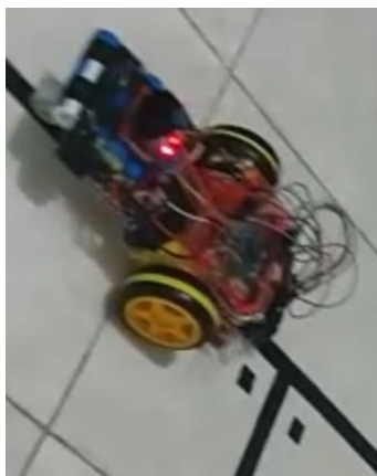
Fig. 7. Señales de bifurcación que el vehículo puede detectar por medio de los sensores reflectivos externos.
