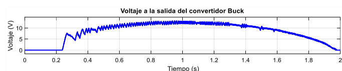
Figura 13. Grafica del Voltaje a la salida del convertidor Buck
